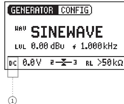
XLR 缆线 2 脚和 3 脚的幻象电压不平衡时，将出现错误提示，幻象电源指示会闪烁 (DC)。
