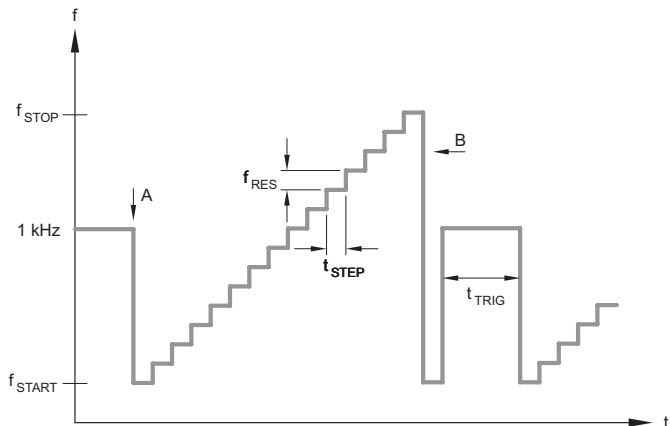
A 频率由 1 kHz 降至起始频率 fSTART, 扫频开始。
