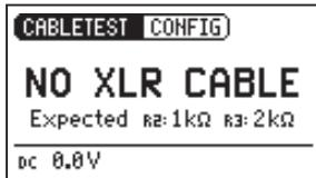
缆线没有正确插入，请检查接线。
