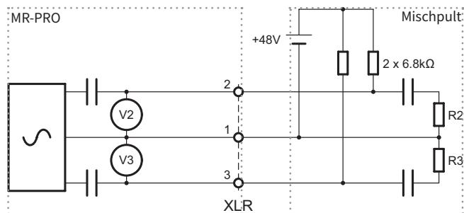
最常见的幻象电源电压是 48V，作用在带有平衡阻抗的 2 脚和 3 脚（见线路图）。
