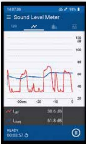
通过设备屏幕即可用三种分辨率查看详细的声压级曲线。时间间隔可以为 100 毫秒或 1 秒。该功能包含在“噪声测量扩展”选件中。
