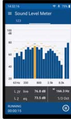
XL3 的一级滤波器组可以在 6.3 Hz 至 20 kHz 之间呈现倍频程或 1/3 倍频程分辨率频谱。所有计算同步进行，两组频谱同屏显示。频率和声压级均可自由滚动缩放。
