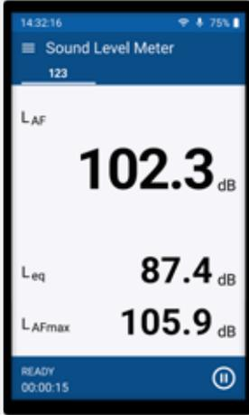
这台一级声级计可以在整个测量过程中同时记录多个声压级参数。XL3 还同时记录频谱数据，录制音频文件也非常简单。
