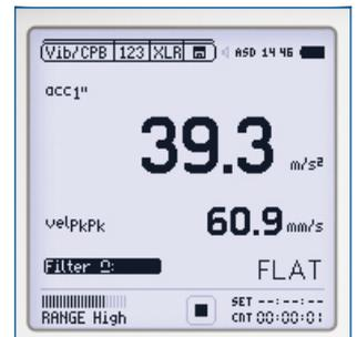
振动选件将 XL2 变成了灵活的振动计, 可以进行低至 0.7 Hz 的 FFT 分析和数据记录。
