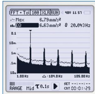
实时 FFT 频谱分析是观察梳状滤波与窄频效应的理想工具。它可以在多个频率范围上量测实时声压级与等效声压级 Leq。
