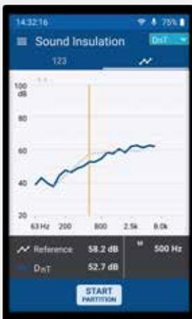
建筑声学扩展选件可以在现场直接测量空气声和撞击声隔声，满足 GB/T 19889, ISO 16283 等标准。只需在声源室和接收室分别测量，即可直接在屏幕读取建筑隔声结果。建筑隔声报告分析软件还能一键生成专业报告。
