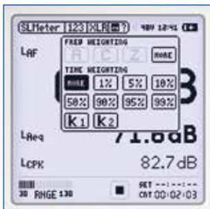
扩展声学包为声压级记录和声学测量提供更多功能, 如记录线性音频文件, 100 毫秒数据记录, 事件监控, 1/3 倍频程分辨率混响时间 RT60 等诸多功能。
