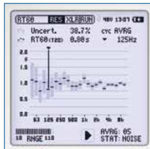
使用脉冲信号或闸控粉噪声自动触发测量 RT60 混响时间。
