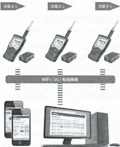
图2 多测试点环境噪声监测网络拓扑图
