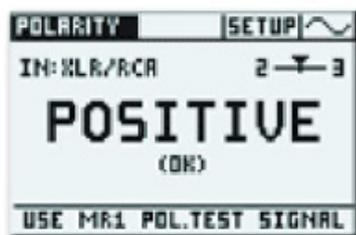
音频分析仪调到极性量测功能，信号输入方式选择XLR/RCA。
