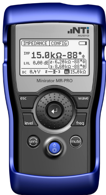
一条5米音频线引脚1出错的测试结果
