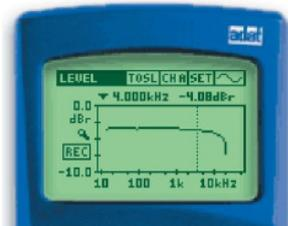
a.不良频响:MR2/MR-PRO作为信号源，选择 ‘Sweep’ 信号。用DL1中 ‘Level RMS Sweep’ 功能量测 A/D 转换器的输出端频响。得到的频响曲线应该一条平滑的图形，误差在 +/- 0.1 dB 之间。
