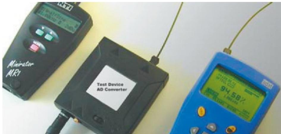
DL1 提供 ‘Level RMS Sweep’ 和 ‘THD+N’ (失真)量测功能，这是检查 A/D 转换器品质的基本参量。A/D 转换器的错误可以被精确地显示在 DL1 的屏幕上：
