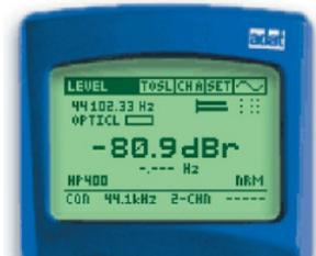
c.直流-补偿和嗡嗡声-问题:内部转换器的缺陷或外部主电源也可能导致数字音频信号的失真。DL1可以检查出这类棘手的问题。选取 ‘Level RMS’ 功能，读取显示的测量值。任何直流补偿或嗡嗡问题度可以被 ‘HP400’ 滤波器给屏蔽掉。因此测量值的任何改变 ( 用滤波器与未用滤波器 ) 就可以指示出问题所在。
