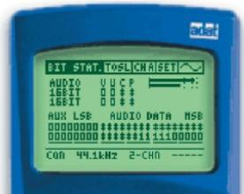
b.卡位 Bit stuck:A/D转换器有时会出现这样的问题：一个数字输出信号不再改变。这就叫做卡位 ( bit stuck ) . 这类错误会导致转换的音频信号失真。DL1 的量测功能 ‘Bit Statistics’ , 可以立即显示出音频分辨率以及那些持续显示 ‘0’ 或 ‘1’ 的位元。
