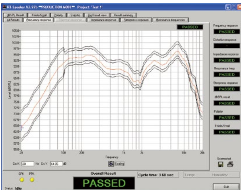
频率响应绝对声压量测
