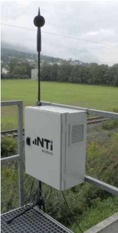
噪声监测终端 麦克风装在三脚架上
