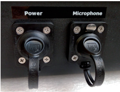
防水接口用于麦克风和外部电源供应 (IP65 级别)
