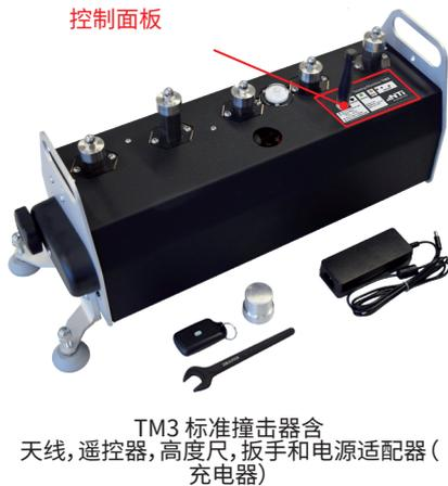
TM3 标准撞击器是精密的建筑声学测量撞击声源。通常用来评估居民楼等建筑内的地板或楼梯上的撞击声。仪器可手动或远程无线开关, 由市电或内置电池供电。
