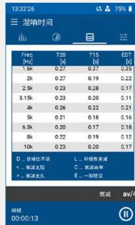
标配支持以 T20 或 T30 方法测量倍频程分辨率混响时间，频率范围 63 Hz - 8 kHz。单个测量点或整个房间的测量结果由 XL3 自动平均。
