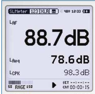
XL2 和麦克风组成了精密声级计。所有测量结果同时可用, 包括 Leq, Lmin, Lmax 和 LCpeak 等, 支持频率计权 A, C, Z 和时间计权快速, 慢速和脉冲(选件)。
