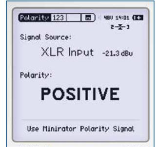
它还能测量扬声器极性, 扬声器阵列延迟时间线, 查看信号的波形。
