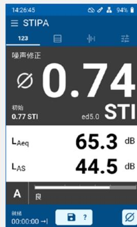
基于最新的 IEC 60268-16:2020 (第五版) 和之前版本测量语言传输指数。它支持环境噪声修正以及自动平均测量结果功能。XL3 以语言传输指数 STI 或通用清晰度指数 CIS 为单位显示测量结果，包含 7 个独立倍频程频带声压级修正与调制函数。
