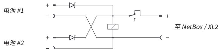
电池连接线接线图
