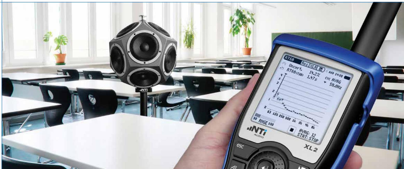
XL2 标配即包含了测量室内和建筑声学的所有功能，包括倍频程混响时间。自动匹配系统可以将测量结果和声源室/接收室或背景噪声等一一匹配。
