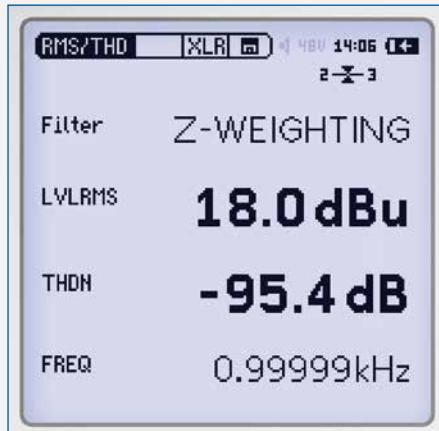
XL2 是具有平衡 XLR 与非平衡 RCA 输入端口的高性能分析仪。可同时量测信号平衡,电平,失真(THD+N)与频率。
