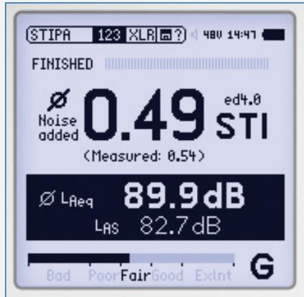
XL2 分析仪基于最新的 IEC 60268-16 和 DIN VDE 0833-4 等标准测量语言传输指数 (STI) 和通用可懂度 (CIS)，包含环境噪声修正以及自动平均测量结果功能。
