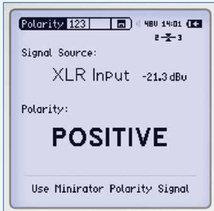
它还能测量扬声器极性,扬声器阵列延迟时间线,查看信号的波形。
