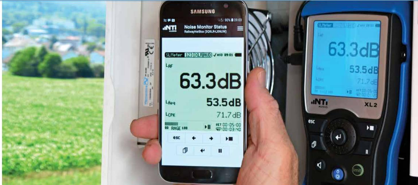
XL2 完全满足噪声测量和监测的需求。它的存储卡提供了充足的容量，用于存储声压级，频谱和音频等数据。通过 USB 接口，即便测量进行中的数据也可以读取。
