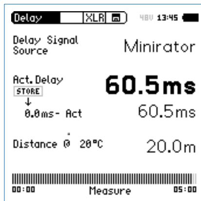
XL2-TA 量测到扬声器 A 相对于电气输入信号的延迟时间(单位:毫秒)。
