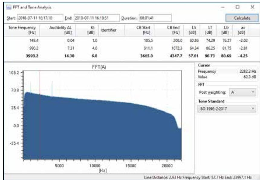
根据 ISO 1996:2-2017, DIN 45681 和 BS 4142:2014 等标准的介绍, 可以根据记录的音频文件按照工程方法计算出 FFT, 以进行客观的音频评估。
