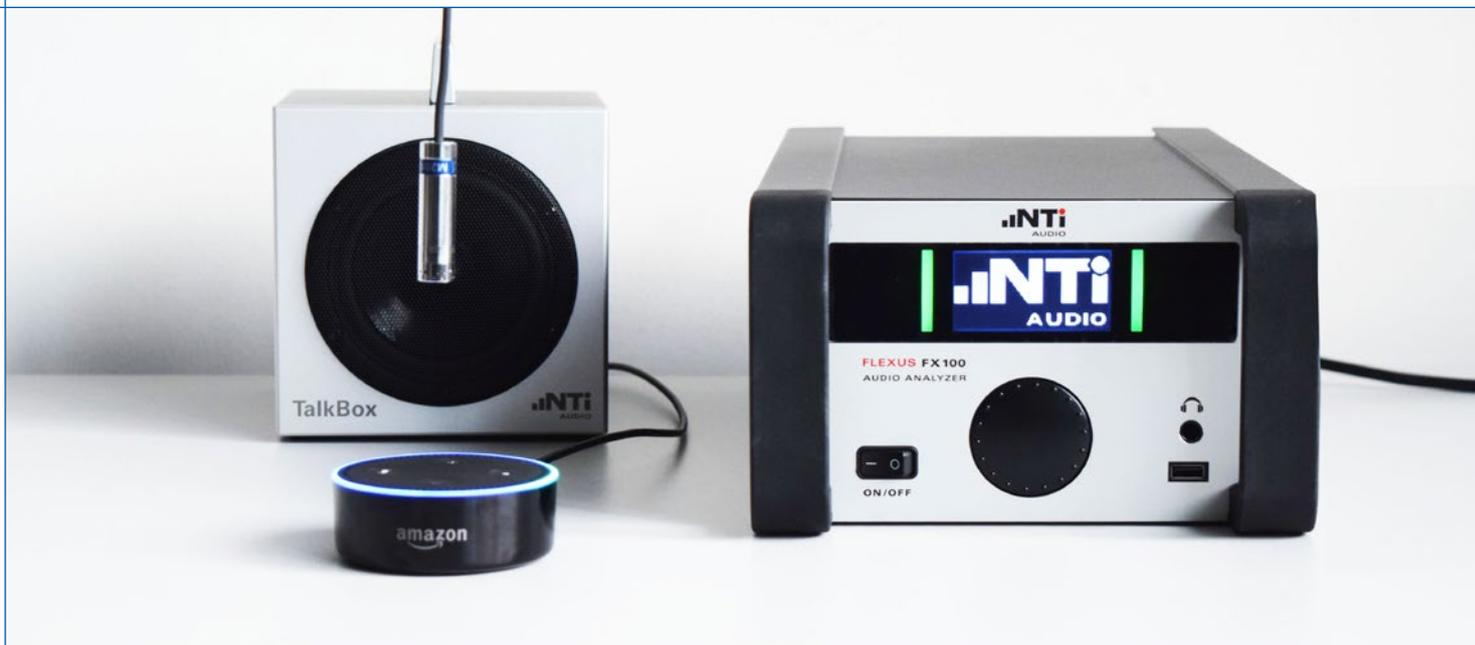
NTi Audio采用独一无二的 PureSound™ 纯音技术检测音频产品杂音, 与人耳听觉 100% 一致。它可测量及量化您所听到的异音瑕疵, 测量速度极快, 在小于一秒的时间内就能完成两个待测体测试, 包括频响、失真、Rub&Buzz(杂音/异音)、声压级等。
