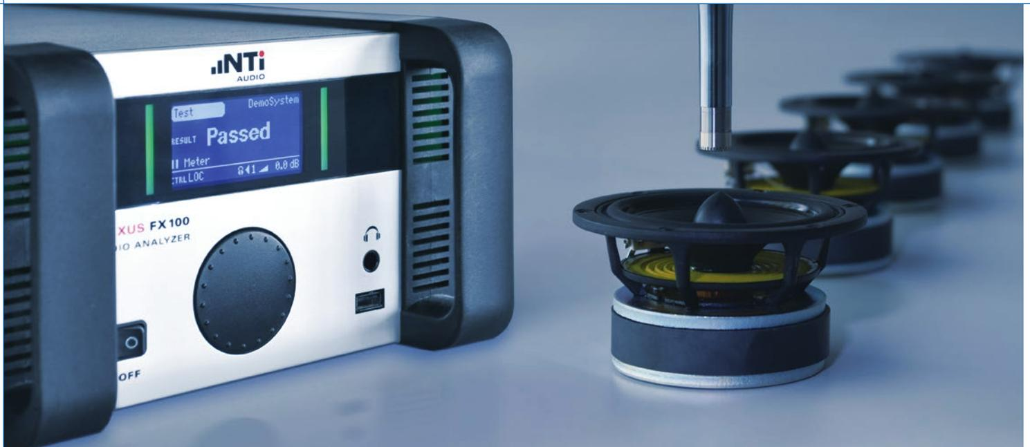
现代一流测试系统必须快速, 简单, 可重现且自动化。NTi Audio 的扬声器纯音测试系统能满足这些要求, 独特的 PureSound™ 异音分析使客观, 可靠, 可重复的测试取代人耳的主观感知。系统基于 FX100 音频分析仪, 适用于对大批量扬声器组件, 预装部件或成品进行在线品控。
